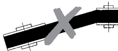
Desalinhamento horizontal dos eixos
